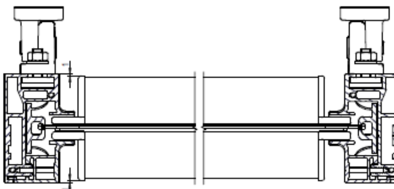
Installation de guides à l'aide de supports (système ZIIIP120)
